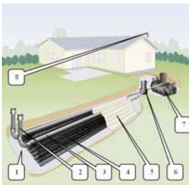
Рис. 6. Общий вид подземного поля фильтрации с использованием фильтрующих модулей.
